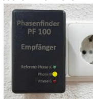
zu prüfende Steckdose 2 gelbe LED: Phase B erkannt
