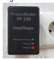
zu prüfende Steckdose 3 rote LED: Phase C erkannt
